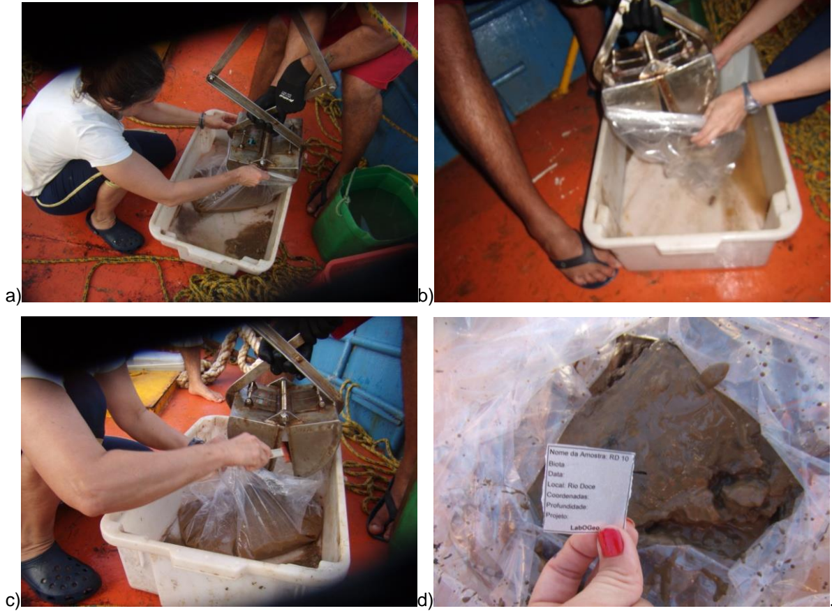
Figura 25. Posicionamento e abertura da draga no interior do saco plástico; C - retirada do excesso de sedimento com espátula; D - registro fotográfico da amostra.
