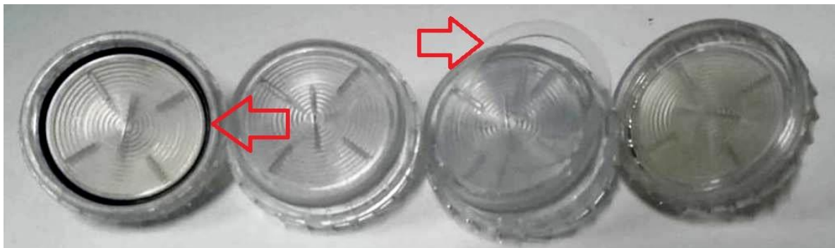
Figura 19. Anéis de vedação ou o-ring's (seta vermelha): lado esquerdo (preto) e de silicone transparente, deslocado no lado direito. Fonte: Laboratório de Fitoplâncton (2018).
