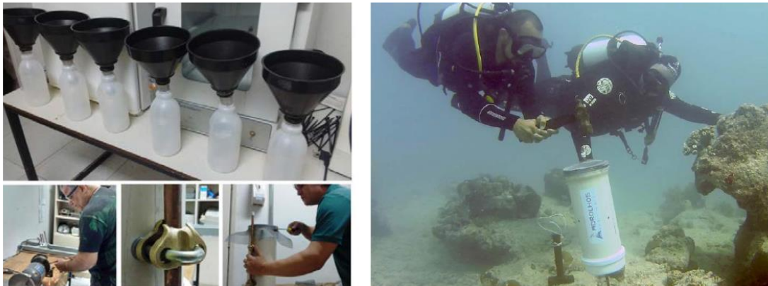
Figura 31. Preparo de armadilhas de sedimento (esquerda) e instalação em campo (direita).
