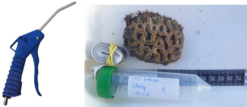
Figura 34. Pistola de ar e amostra de coral para raspagem de tecido.
