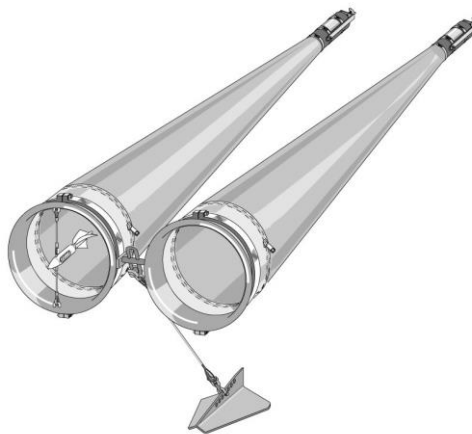
Figura 21. Rede de plâncton tipo bongo com duas redes de abertura de malha de 200 micrômetros e defletor.
