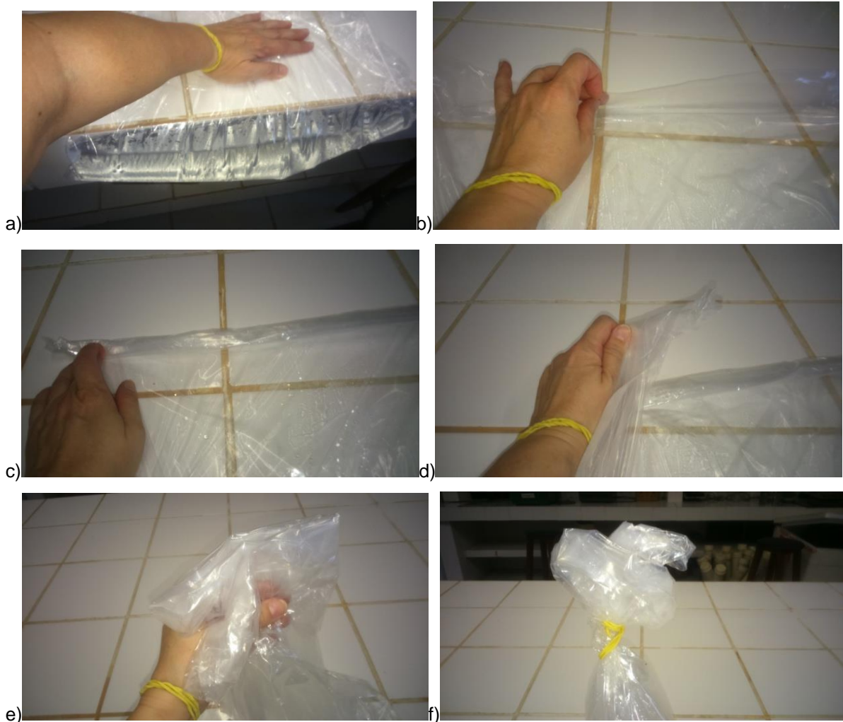
Figura 26. A - retirada do excesso de ar do saco plástico; B e C - dobras estreitas a partir da abertura até cerca de metade do saco, sem pressionar a amostra; D e E - dobras das duas extremidades em direção ao meio; F - elásticos colocados no saco fechado com as dobras.
