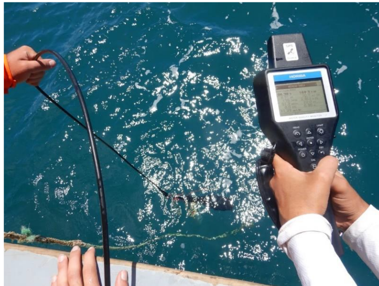
Figura 2: Coleta de dados em campo para mensuração das variáveis ambientais utilizando sonda multiparâmetro
