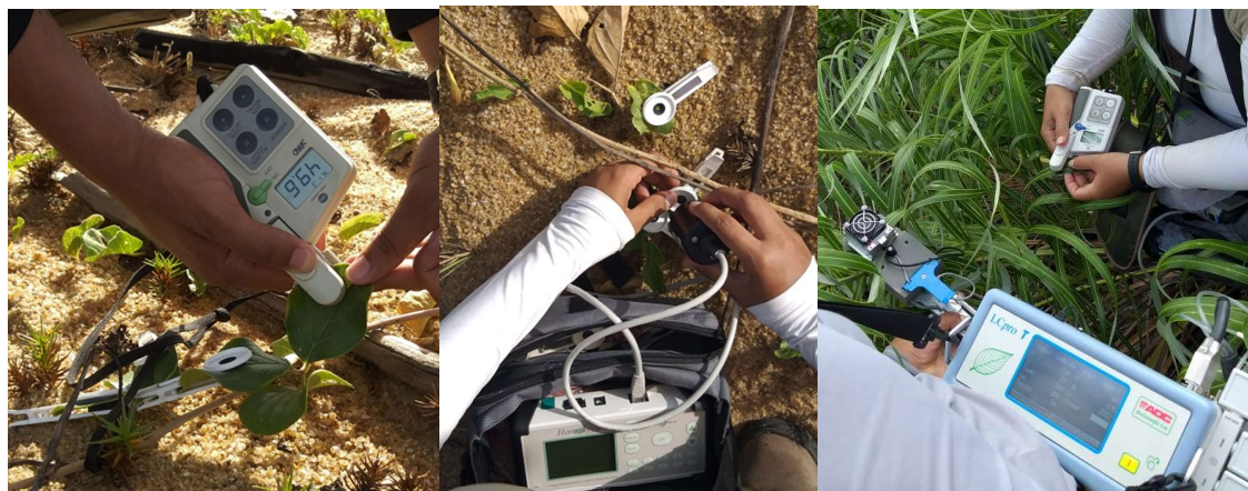
Figura 6: Determinações fotossintéticas in situ em plantas da Restinga, avaliadas em janeiro a agosto de 2019 com o auxílio de equipamentos portáteis: Clorofilômetro modelo SPAD-502 (A); Fluorômetro modelo HandyPEA (B) e Analisador de gás a infravermelho - IRGA, modelo LCPro T System (C).
