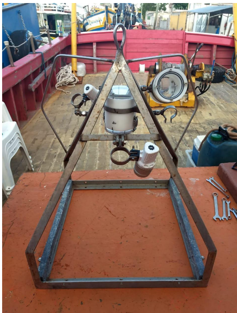
Figura 2: Foto da estrutura metálica (dropcâmera).
