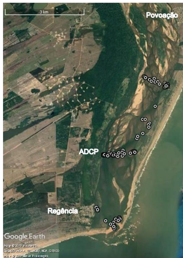
Figura 6: Locais de monitoramento de salinidade e temperatura, próximo à foz do rio Doce, com indicação da seção (ADCP) onde são medidos fluxos d'água.
