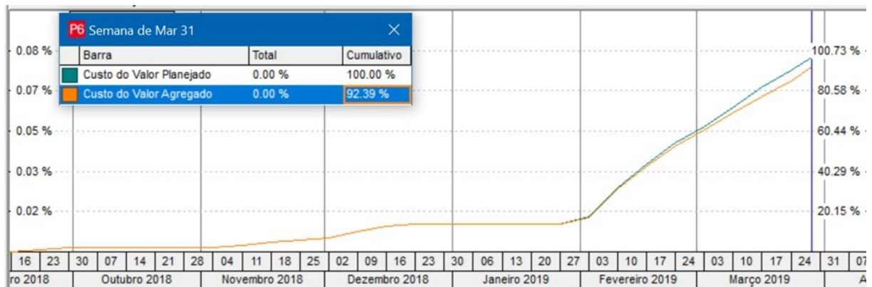
Figura 9: Curva S representativa das atividades de campo com avanço percentual do Anexo 4 (Programa de Monitoramento da Morfodinâmica) executado pela RRDM.
