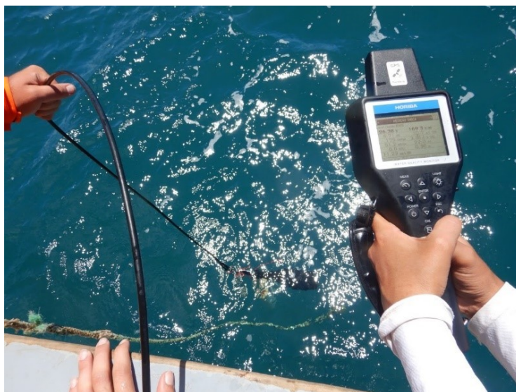
Figura 5: Coleta de dados para mensuração das variáveis ambientais utilizando sonda multiparâmetros Horiba modelo U52-G em campo
