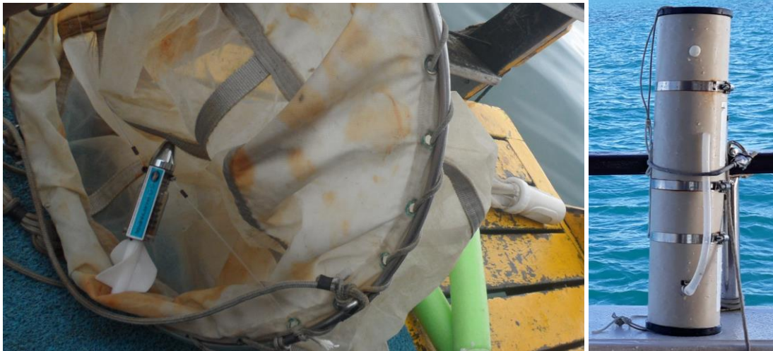
Figura 29. Rede de Plâncton e Garrafa Niskin para coleta do plâncton.
