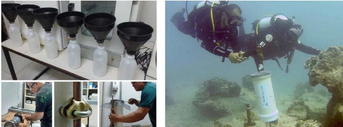
Figura 28. Preparo de armadilhas de sedimento (esquerda) e instalação em campo (direita).
