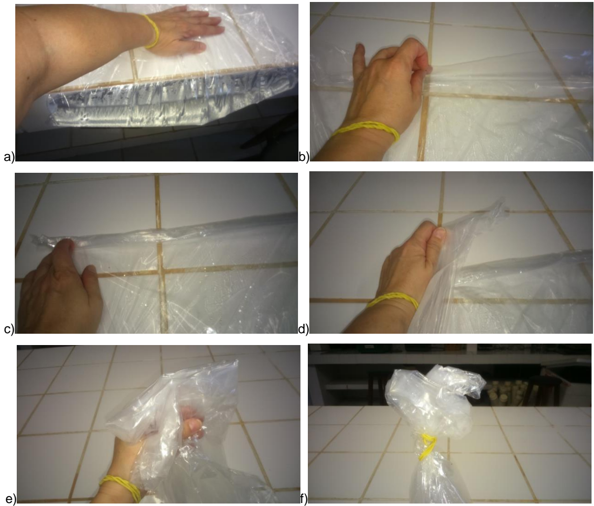
Figura 23. A - retirada do excesso de ar do saco plástico; B e C - dobras estreitas a partir da abertura até cerca de metade do saco, sem pressionar a amostra; D e E - dobras das duas extremidades em direção ao meio; F - elásticos colocados no saco fechado com as dobras.
