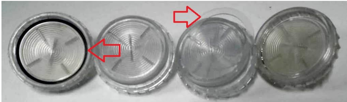
Figura 17. Anéis de vedação ou o-ring's (seta vermelha): lado esquerdo (preto) e de silicone transparente, deslocado no lado direito. Fonte: Laboratório de Fitoplâncton (2018).
