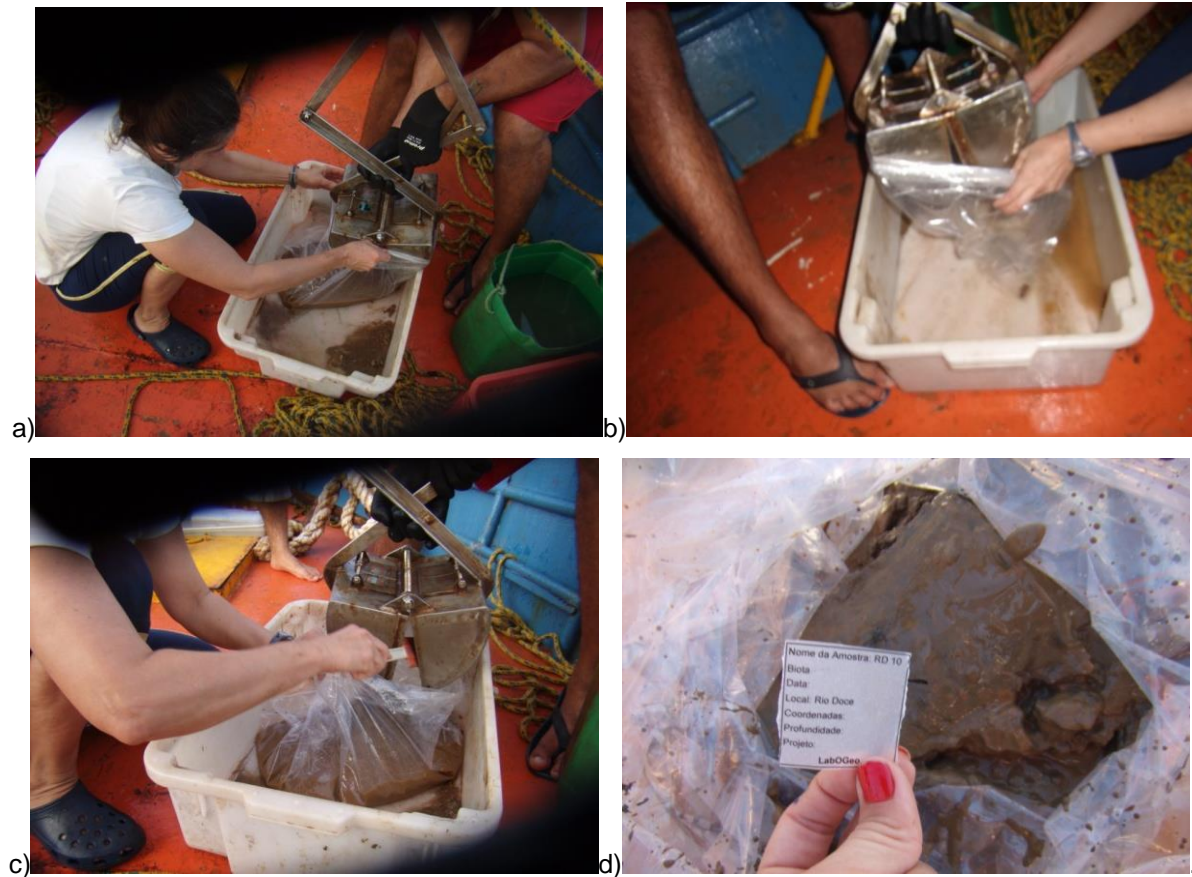
Figura 22. Posicionamento e abertura da draga no interior do saco plástico; C - retirada do excesso de sedimento com espátula; D - registro fotográfico da amostra.
