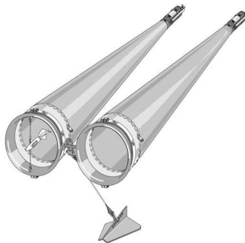
Figura 19. Rede de plâncton tipo Bongo com duas redes de abertura de malha de 200 micrômetros e defletor.
