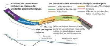
Figura 17: Modo de classificação dos "Habitats Físicos" utilizado na abordagem adotada pela Empresa NHC adaptado da literatura (BISSON et al., 2017, MONTGOMERY, D. R., & BUFFINGTON, 2007, 2008).
