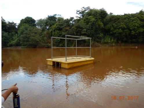
Figura 2: Registro de estação fixada em catamarã.
