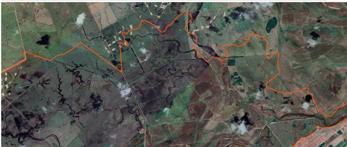
**Figura 12:** Área exemplo com a linha de mancha de inundação após resolução. observa-se a direita inferior que a mancha tem alta correspondência com a curva de nível. observa-se a esquerda que a mancha também tem grande correspondência com os canais de drenagem.
