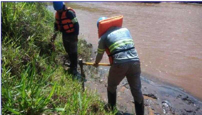
Amostragem de sedimento estratificada até 2,0 m de profundidade, utilizando-se amostrador tubular e *liner* descartável para armazenamento da alíquota de sedimento.
