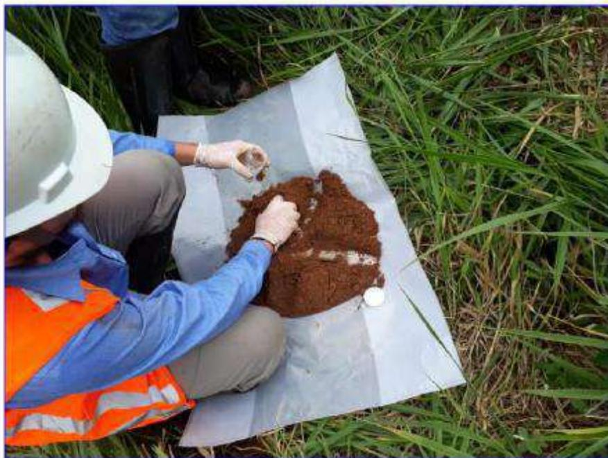
Quarteamento da amostra de solo coletada e seleção das porções opostas para composição da alíquota a ser encaminhada para análises químicas.
