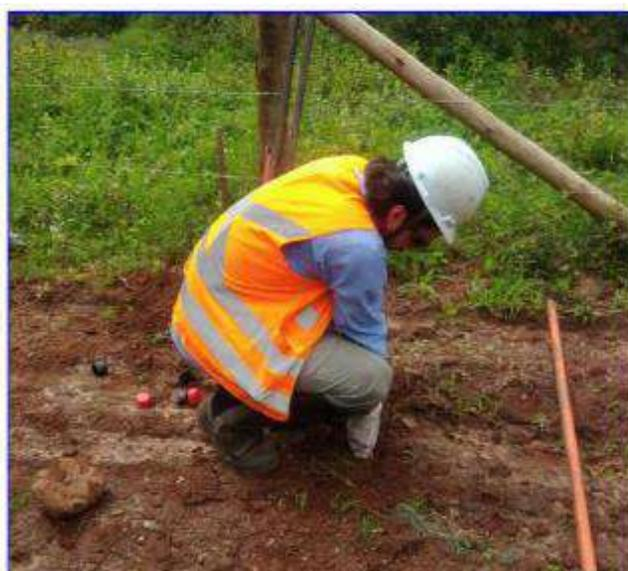
Coleta de solo superficial (até 20 cm), seguindo a mesma técnica de coleta utilizada pela AMBIOS, onde definiu-se uma circunferência de 2m de raio e a dividiu em 8 pontos localizados a 2m do centro da mesma. A coleta foi realizada através do cravamento de um tubo de PVC, até a profundidade definida.
