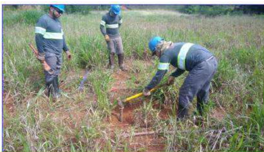
Amostragem de solo estratificada até 2,0 m de profundidade, utilizando-se amostrador tubular e liner descartável para armazenamento da alíquota de solo.
