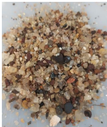
Figura 20 - amostra retida na peneira de 0,6 mm para ensaio de teor de argila em torrões e materiais friáveis
