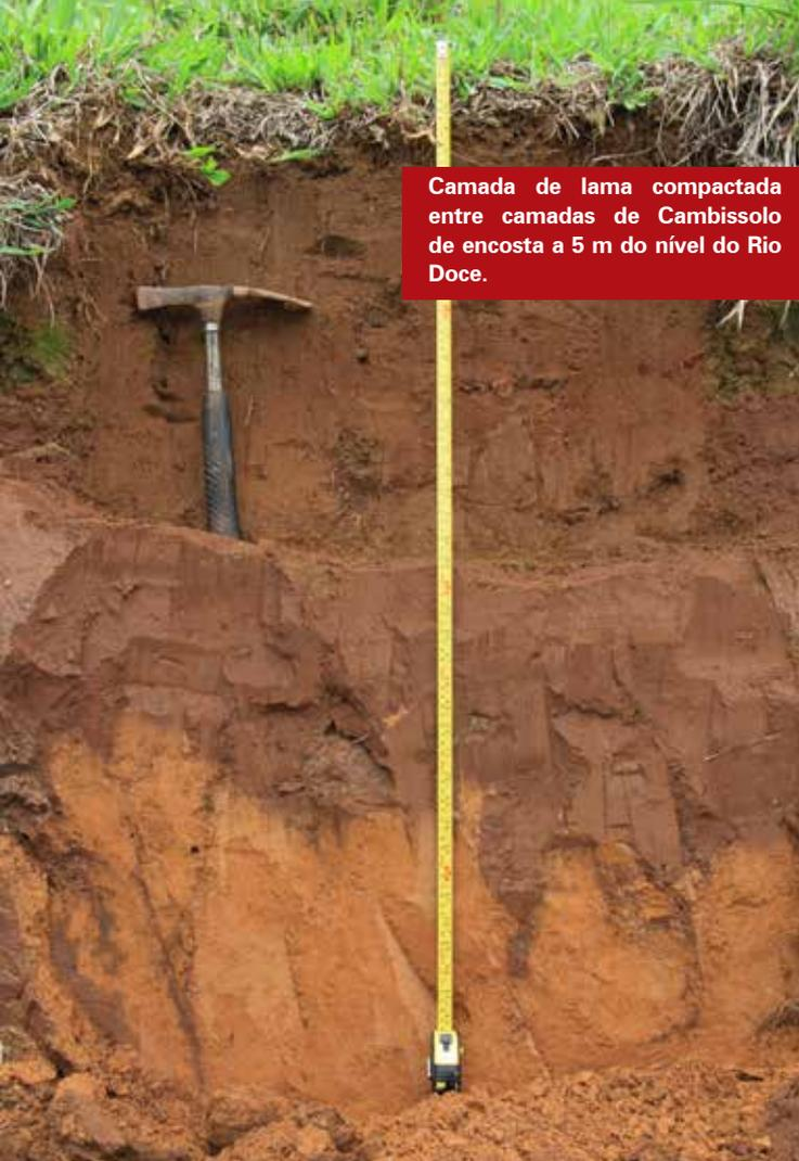
Camada de lama compactada entre camadas de Cambissolo de encosta a 5 m do nível do Rio Doce.
