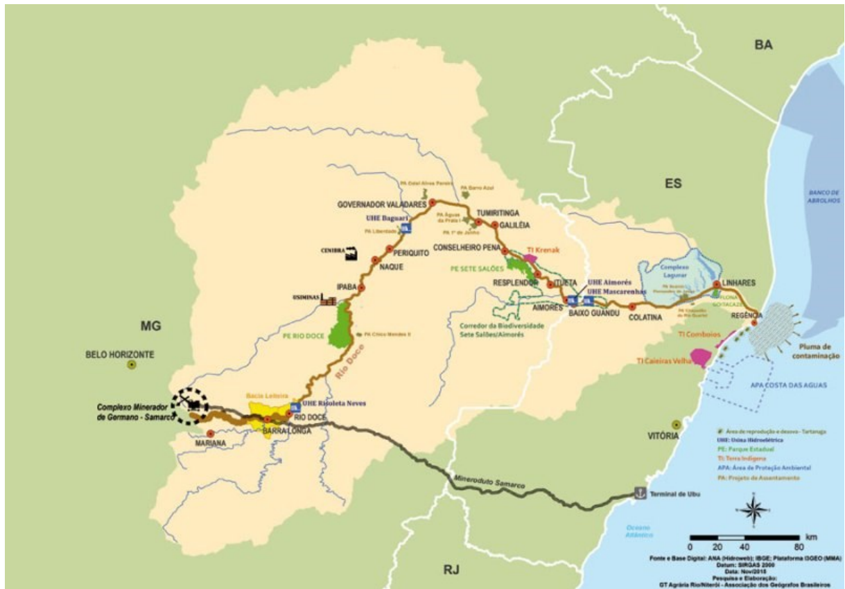
Figura 16 - Trajeto da onda de rejeitos provocada pelo rompimento da barragem de Fundão
